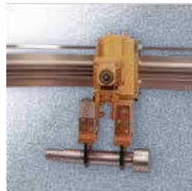
シャフト搬送例 ダブルチャック・フローティングヘッド付 (同一姿勢搬送)
